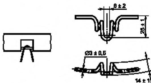
Рисунок 6 — Пример крючков для крепления сетки
